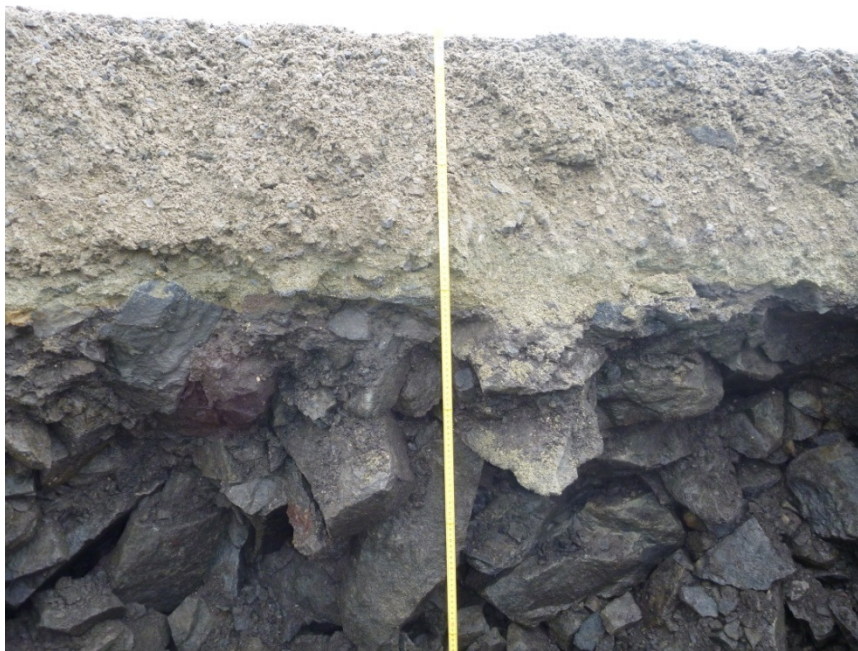
Figur 4: Prøvegrop SP8. 40 cm avrettingslag av sand og grus over sprengstein.
