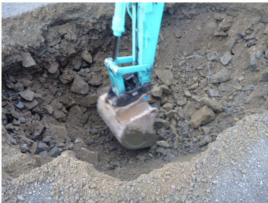
Figur 3: Prøvegrop SP2. Massene besto av et ca. 0,5 m tykt avrettingslag av grus og sand over sprengstein.
